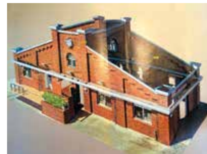
3次元レーザースキャナーを活用して構築した立体図
