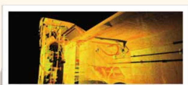
矩形トンネル内にある配管類の3D点群データ
