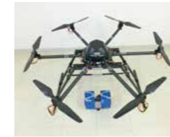
<試作開発した計測用マルチコプター> 購入したマルチコプターに3Dレーザースキャナ・特殊映像伝送装置・カメラ・大容量バッテリーを搭載し、テスト飛行により運航制御を確立させ、安定した計測を実現した。
